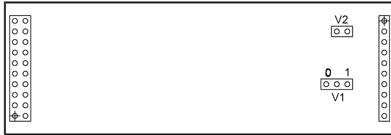
Obr.9.3 Umístění konfiguračních propojek na desce OT-11
