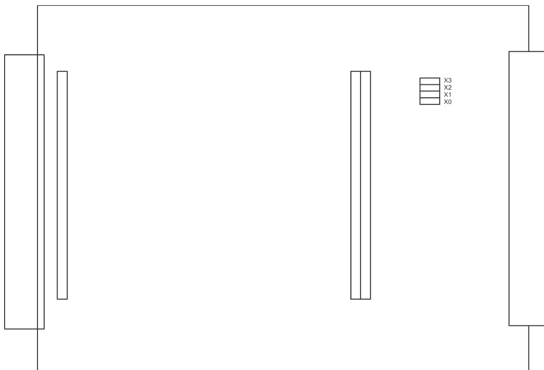
Obr.4.1 Umístění adresovacích propojek na procesorové desce GX-05 v jednotkách CD-01 a CD-02
